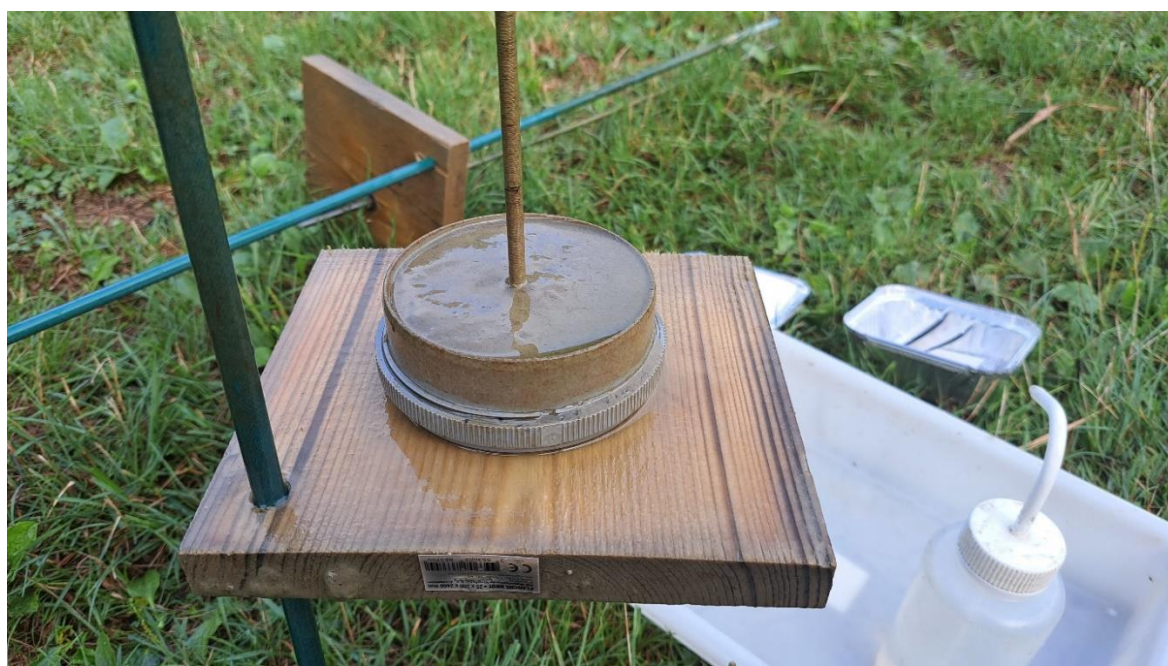
Figure 19 : Piège à sédiments (mesure de la sédimentation) au moment du prélèvement après trois mois dans l'étang.
