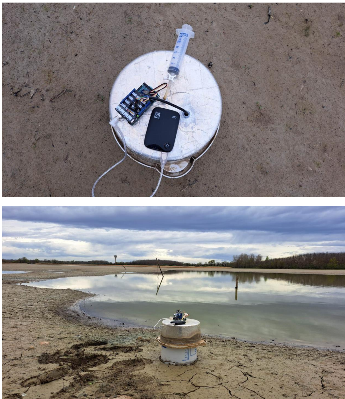
Figure 22 : Dispositif utilisé pour mesurer les émissions de CO 2 et de CH 4 durant la phase d'assec des étangs.
