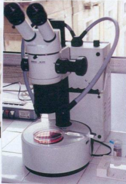
à gauche, platine chauffante (80°C) à droite, microscope optique équipé d'un objectif à immersion (X 6 à 1500)
