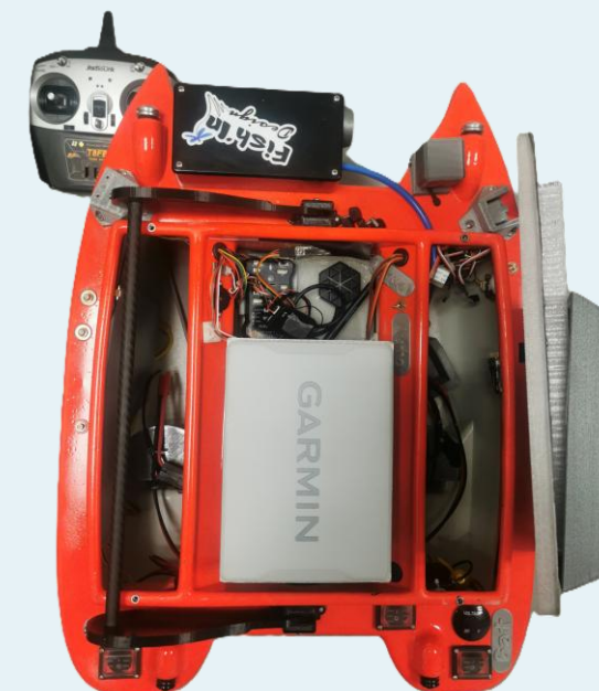
Bateau radiocommandé bathymétrie – Kargo'Pro
