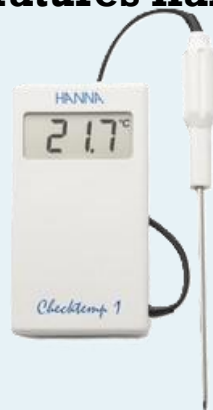
Sonde enregistreuse de températures Hanna
